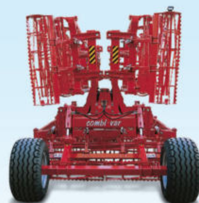
Macchina chiusa per trasporto su strada Closed machine pulling transport on the road
